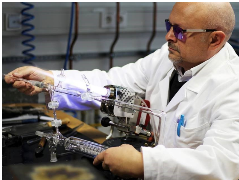
Bernhard Werner bei der Arbeit an einem Kolonnenkopf
